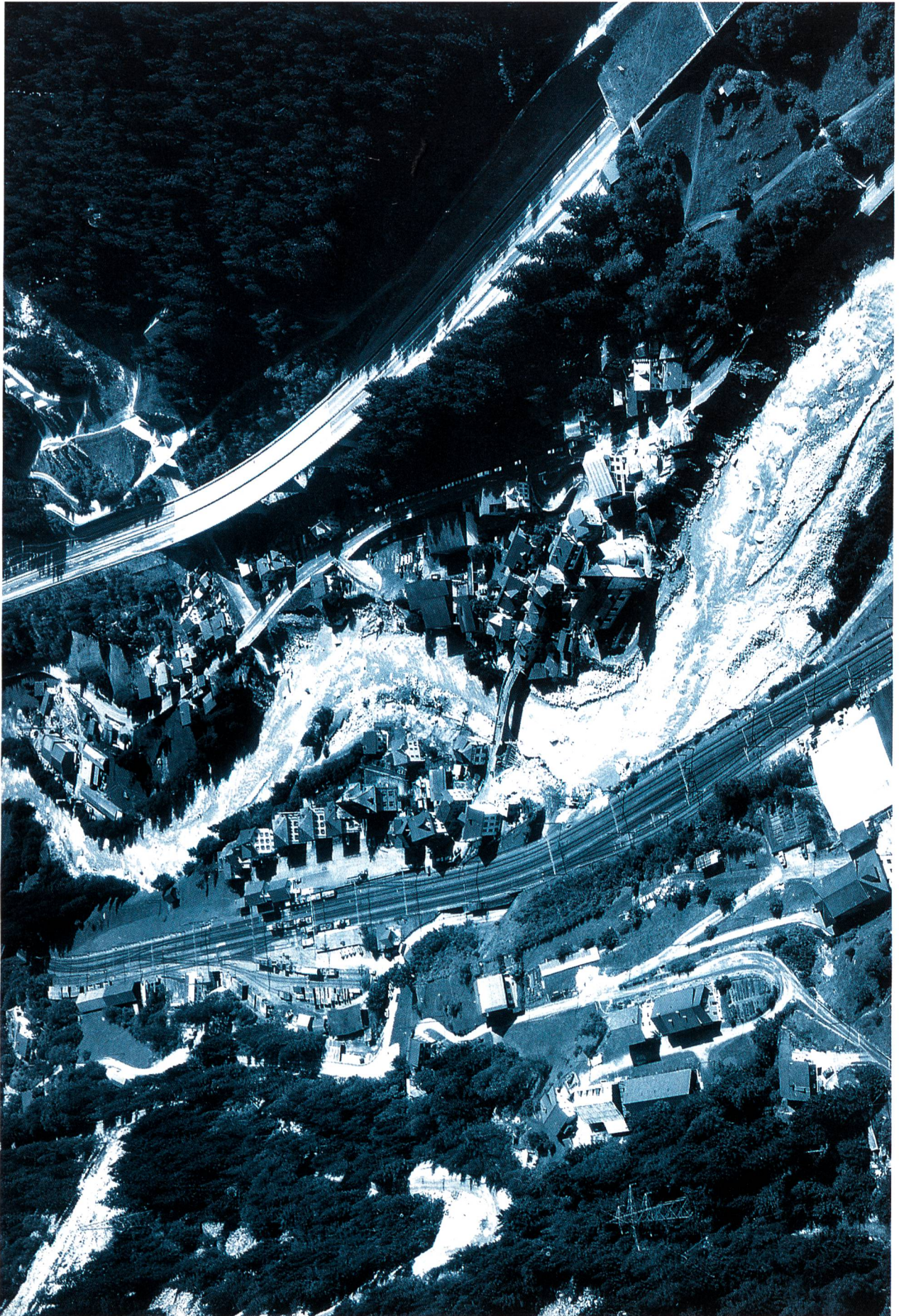
Das Dorf Gurtellen, die Reuss, die Autobahn N2 und die Gotthardlinie der SBB. Im Bild fliesst die Reuss von rechts nach links. Erkennbar sind die durch das Hochwasser 1987 ausgeweiteten Flussmäander, Erosion und Kiesbänke. (Comet Photo AG, Zürich, Bild 87-5315).
