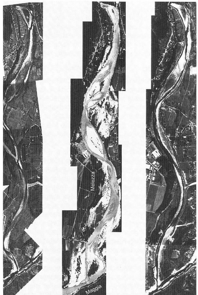
Bild 3. Luftbildaufnahmen des rund 4,3 km langen Abschnittes der Melezza in der Alluvionsebene vor dem Zusammenfluss mit der Maggia. Die Aufnahmen stammen aus den Jahren 1966/68 (links), 1978 – unmittelbar nach dem Hochwasserereignis – (Mitte) sowie 1996 (rechts). Fließrichtung jeweils von oben nach unten.
