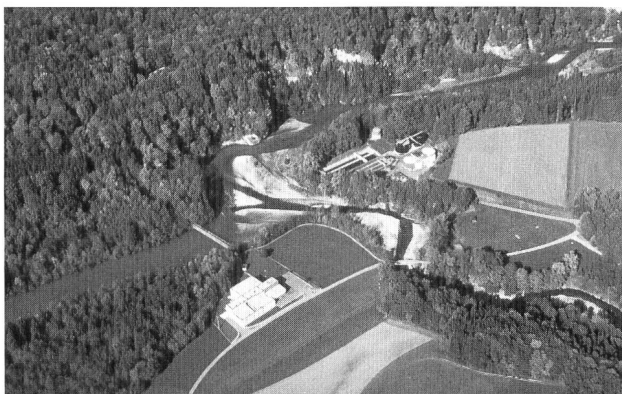
Figure 15. Confluence de la Gérine avec la Sarine. Le rehaussement de lit de la Sarine, dû aux apports de la Gérine a des incidences sur le fonctionnement de l'usine des traitements d'eau potable du Grand-Fribourg (Photo J.Cl. Bersier, Fribourg).
