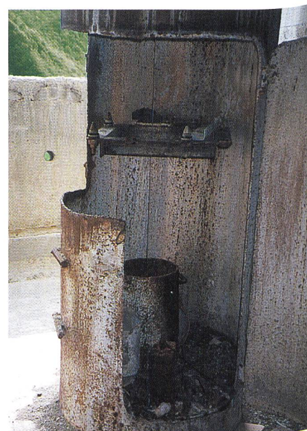
Bild 2. Detail eines Lotes zur Verformungsmessung.
