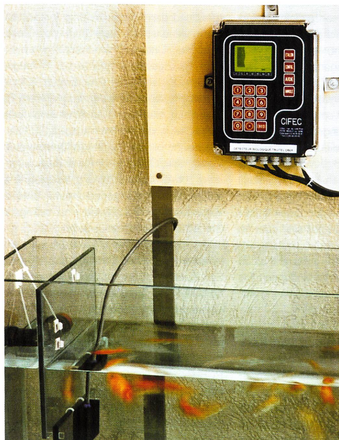
Bild 1. Prüfgerät «Truitel» zur Erfassung des Bewegungsverhaltens von Fischen.
