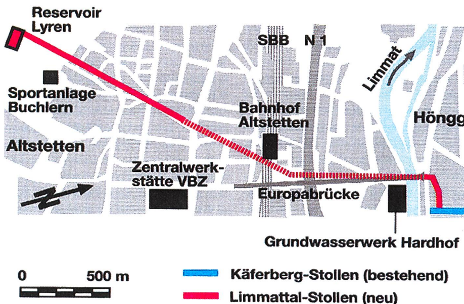
Bild 2. Situation Trinkwasserstollen Limmattal.
