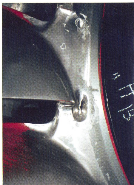
Bild 5. Ausgeschliffene Risse an einem alten Laufrad.
