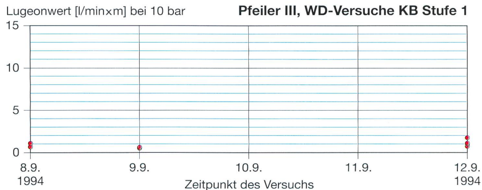
Bild 6.14. Ergebnisse der WD-Versuche nach Abschluss der Injektionen.
