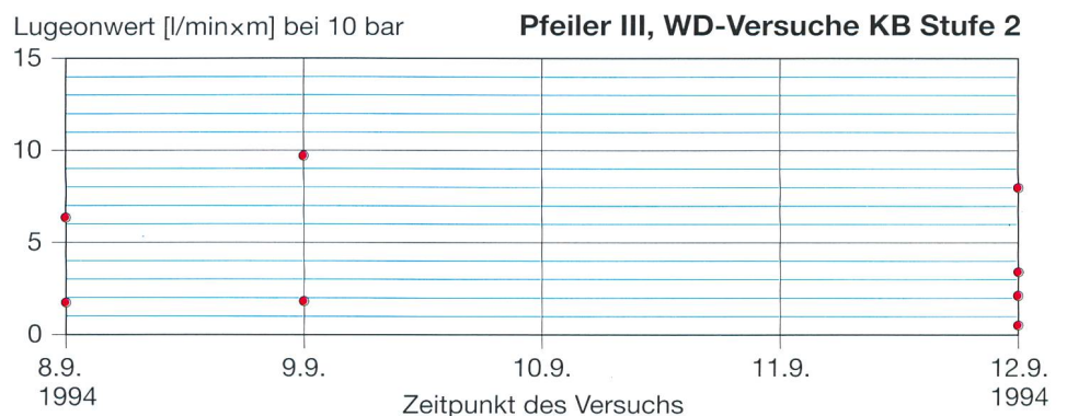
Bild 6.7. Ergebnisse der WD-Versuche nach Abschluss der Injektionen.
