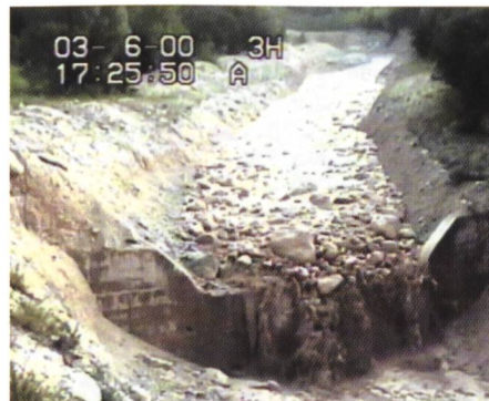
Bild 8. Der Murgang vom 3. Juni 2000: Das Videobild (Bild 8a) zeigt die Murenfront mit einer Höhe von 1,3 m und einem Maximalabfluss von 19 m 3 /s. Die mittlere Frontgeschwindigkeit beträgt in diesem Gerinneabschnitt 1,3 m/s. Der Murgang vom 28. Juni 2000: Das Videobild (Bild 8b) zeigt den Hauptschub mit einer Höhe von 2,2 m und einem Maximalabfluss von 125 m 3 /s. Die mittlere Frontgeschwindigkeit beträgt in diesem Gerinneabschnitt 4,7 m/s.
