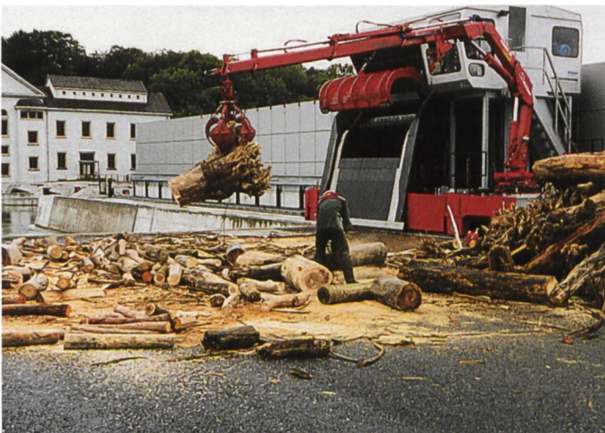
Bild 3. Gesamtanlage Rechenreinigung mit anspruchsvollen Zusatzanforderungen.
