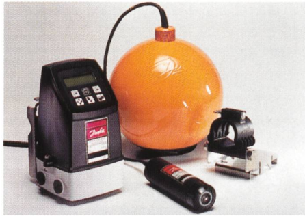
Bild 1. Die komplette Sauerstoff-Messstation Evita-Oxy besteht aus Messumformer, Sensor, selbstreinigender Schwimmerkugel und Befestigungszubehör (Werkfoto: Danfoss AG).
