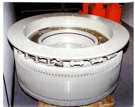
Bild 4. Erregerrotor mit Diodenbrücke.
