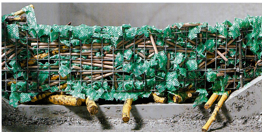
Bild 3. Verlegung eines Netzes im hydraulischen Modell; die grünen Stofflappen simulieren den Schwemmholzfeinanteil wie Laub oder kleine Äste (Blick gegen Fliessrichtung).
