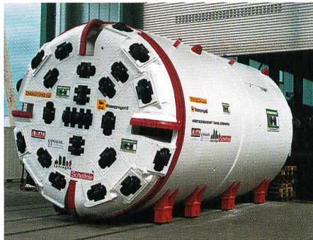
Bild 1. Die Tunnelbohrmaschine S-163 bei der Abnahme im Herstellerwerk.
