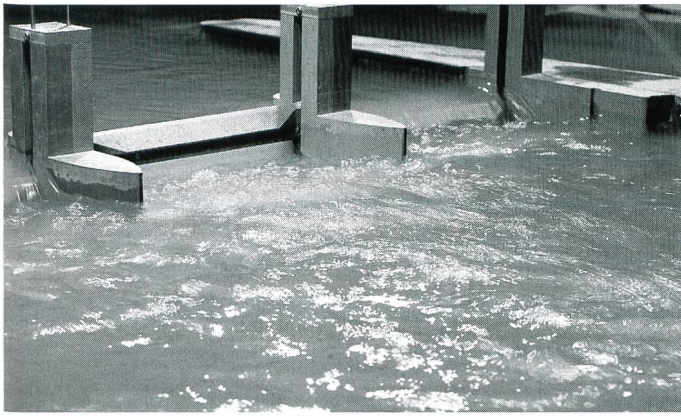
Bild 16. Links: Nach oben gerichteter Ausflusstrahl mit Deckwalze und kurzer welliger Übergang zum strömenden Abfluss. Rechts: Abflussverhältnisse vom 4. bis 13. Juni 1999: frei nach unten gerichteter Ausflusstrahl und kreuzende Stosswellen. In der Nachlaufströmung (Bild 17) bildet sich ein ondulierender Wassersprung. Solch «kleine» Wassermengen werden normalerweise durch Überströmen und nicht konzentriert durch ein Wehrfeld abgeleitet.
