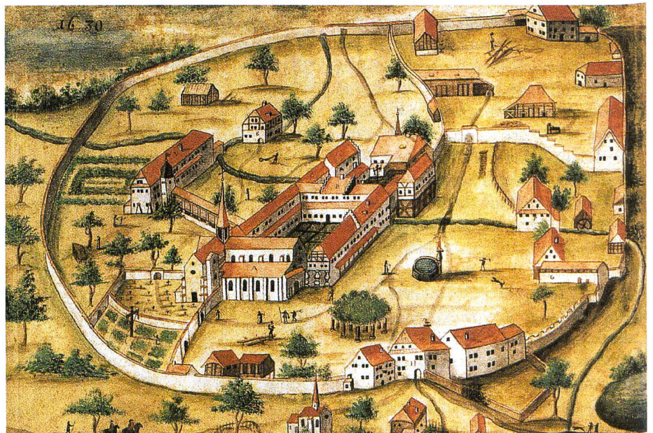
Bild 6. Aquarell der 1194 gegründeten Zisterzienserabtei St. Urban um 1630. Der kanalisierte Stempech tritt zweiarmig in die Klosterumfriedung ein (oben links), geht am Badhaus und dem Krankenhaus vorbei, unterquert im Klausurgebäude die Schlafsäle, den Speisesaal und die Küche und anschliessend ein Gewerbegebäude. Vor seinem Austritt aus der Klosterumfriedung treibt er eine Getreidemühle an. Oben links ist ein Mühleleich, unten rechts sind zwei Fischteiche zu sehen (aus Hörsch 1994).
