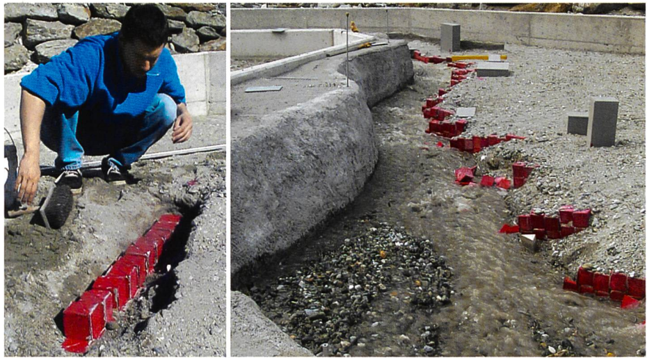
Bild 7. Einbau der Blockbühnen im Modell (links); freigespülte Schutzbauten im Versuch 8 für 150 m 3 /s (rechts).
