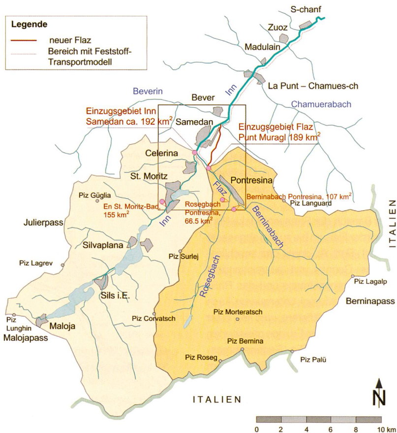
Bild 1. Einzugsgebiete von Inn und Flaz bei Samedan mit neuem Flazlauf (rot) und Bereich mit Feststofftransportmodell (Ausschnitt siehe Bild 3).
