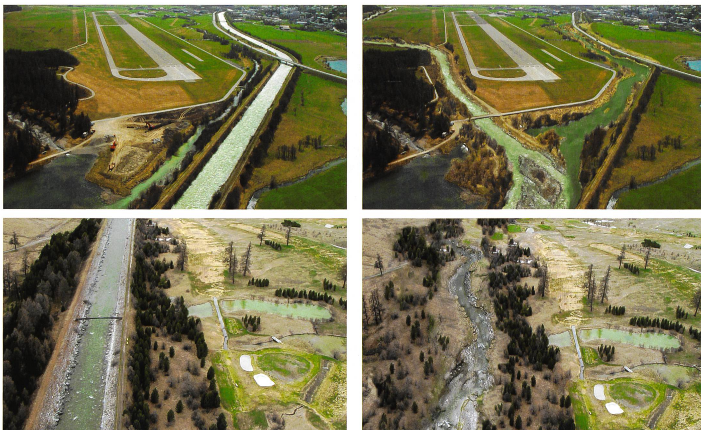
Bild 2. Zwei Beispiele für die Visualisierung von Entwicklungszielen. Oben links: neue Flazmündung vor der Baumassnahme; oben rechts: Fotomontage des angestrebten Zustands. Unten links: alter Flazkanal Höhe Golfplatz; unten rechts: Fotomontage des angestrebten Zustands des Flaz vegl (Fotos und Fotomontagen: Rey).
