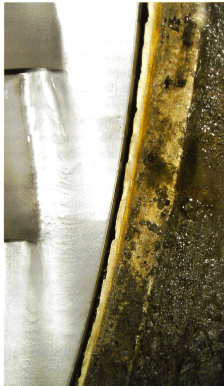
Bild 10. Auswaschungen im Labyrinthspalt.
