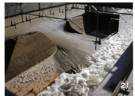
Figure 8. 1) Ouverture de la brèche 2) Allongement de l'ouverture.
