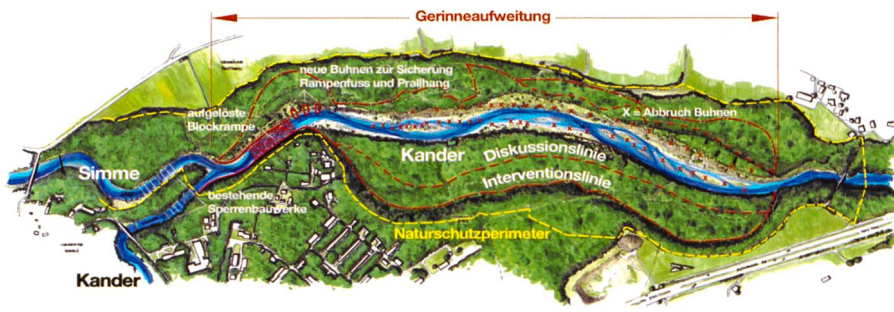
Bild 4. Gesamtprojekt Augand, Massnahmen und Endzustand.
