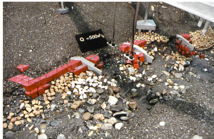
Bild 7. Bei der Nationalstrassenbrücke Wassen sind die drei bühnenförmigen Betonscheiben, welche die Strömung vom linken Ufer abweisen durch Betonprismen vor Hinterspülung geschützt. Zustand im hydraulischen Modell nach einem Abfluss von 500 \text{ m}^3/\text{s} (Fließrichtung von links nach rechts).
