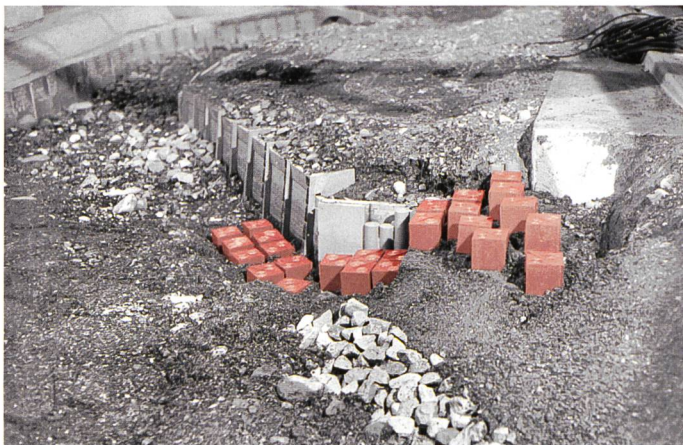
Bild 6. Flussaufwärtiges Ende der rechten Uferschutzmauer in Gurtellen beim Einbau der Prismen im hydraulischen Modell. Die in der Flusssohle und der Böschung vergrabenen Elemente schützen die Mauer vor Unterkolkung (Blick in Fließrichtung).
