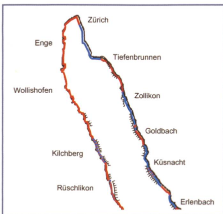
Bild 9. Kartenausschnitt aus der geologischen Eignungskarte. Auf den rot eingezeichneten Uferabschnitten ist der Untergrund problematisch: Dort findet man Rutschungen, unvertefzte Schlämme oder Seekreide. Auf den blauen Strecken ist der Untergrund vermutlich fest. Wo vorhanden, ist auch die Böschungskante unter Wasser eingezeichnet.
