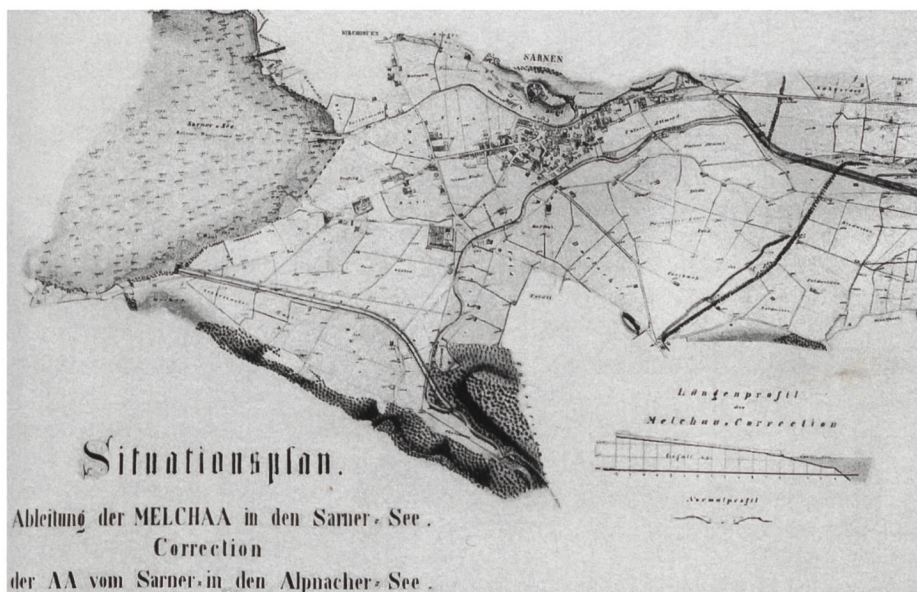
Bild 1. Melchaa- und Sarneraa-Korrektion. Situationsplan 1:5000 (Ausschnitt), mit Längsprofil und Normalprofil, wohl von Ingenieur Caspar Diethelm in den 1870er Jahren gezeichnet und vielleicht die einzige Plangrundlage für die Ausführung (Foto D. Reinhard, Sachseln).
