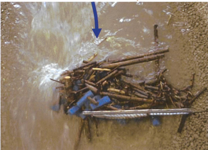
Bild 10. links: Modellversuche zu «Teilnetzen» in Kurven; rechts: Modellversuch zu v-förmigen Netzen.
