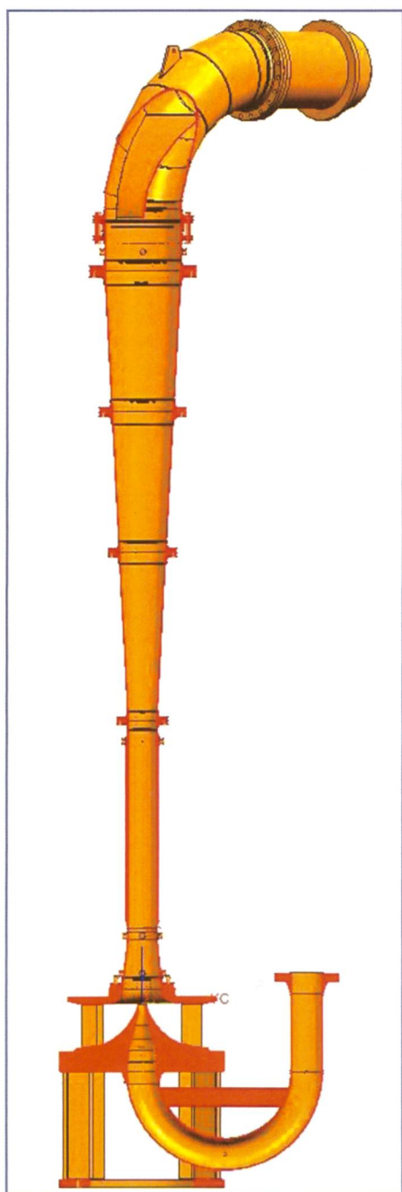
Bild 5. Zusammenstellung der Strahlpumpe und Schnitt durch den Einlaufbereich.
