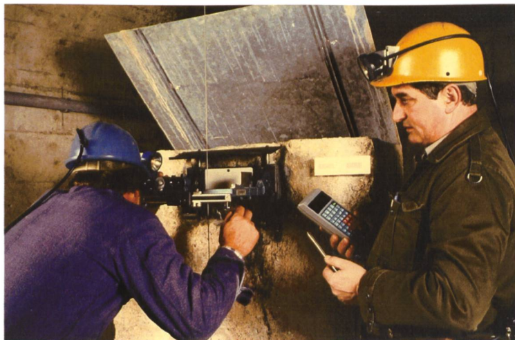
Figure 8. Mesure de déformation par pendule dans une galerie d'un barrage. (Source: Emosson SA).
