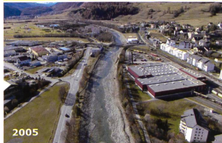
Bild 7. Linke Bildleiste: En-Kanal in Samedan (Blick von Quadratscha En-aufwärts in südlicher Richtung): Die stark reduzierte Wasserführung des En in Samedan erlaubte es, die Hochwasserdämme massiv abzusenken und damit ausreichenden Raum für Restrukturierungsmassnahmen im alten Kanalgerinne zu schaffen. Das Entwicklungspotenzial für die Massnahme erwies sich letztlich grösser, als noch bei der Formulierung und Visualisierung der Entwicklungsziele erwartet werden konnte.
