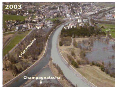
Bild 11. Zusammenfluss von Flaz vegl und En (Blick von Champagnatscha En-abwärts in nördlicher Richtung): Die auffälligste Veränderung im Bereich der alten Flazmündung ist die nun veränderte Wasserführung. Während 2003 En (von links) und der durch Gletschermilch getrübe Flaz (von rechts) noch weitgehend unvermischt durch Samedan flossen, enthält das nun restrukturierte En-Gerinne seit 2005 nur noch Wasser aus En und Flaz vegl.
