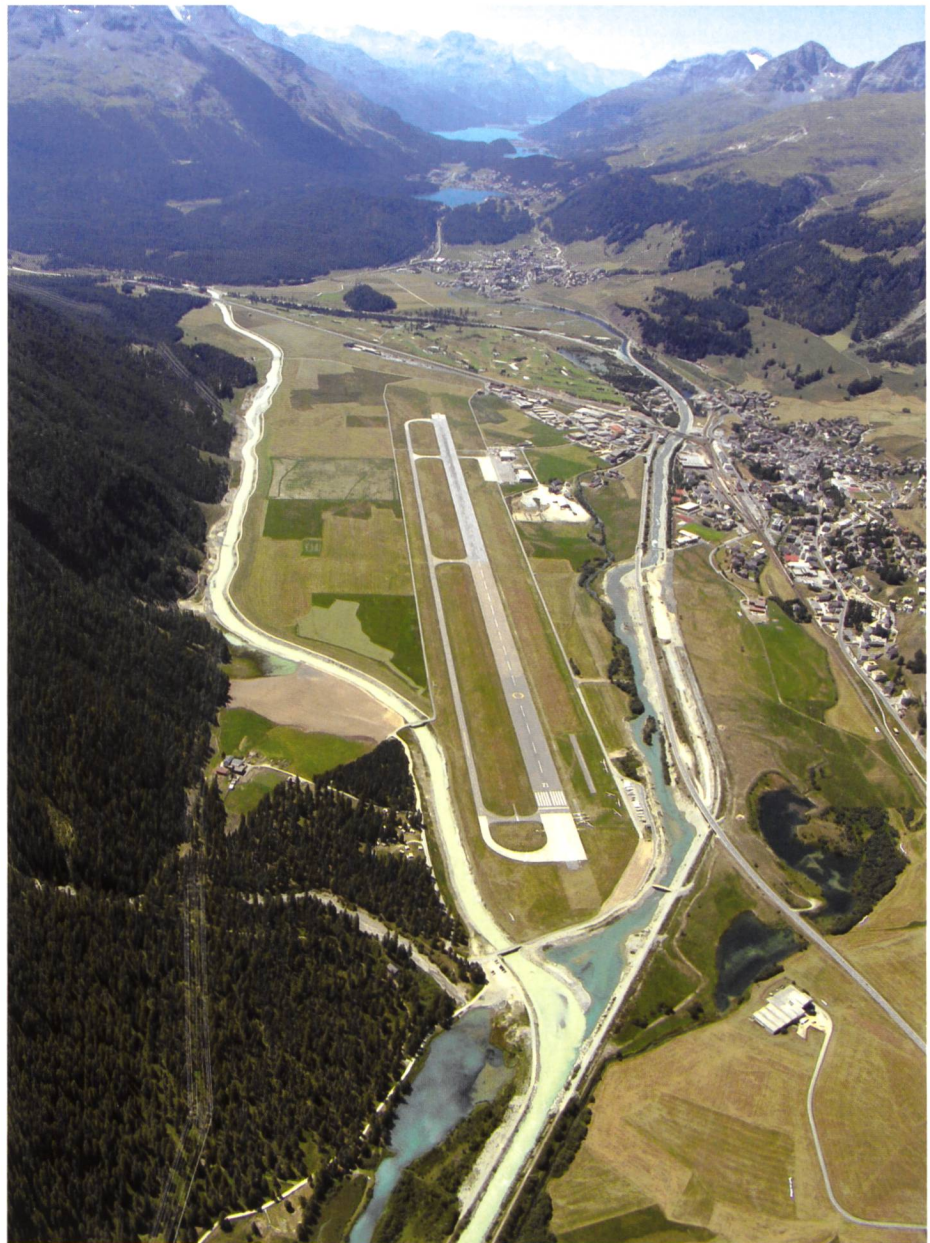
Bild 1. Durch die Flussverlegung des Flaz konnte eine umfassende Restrukturierung der Gewässer in der Ebene von Samedan umgesetzt werden.
