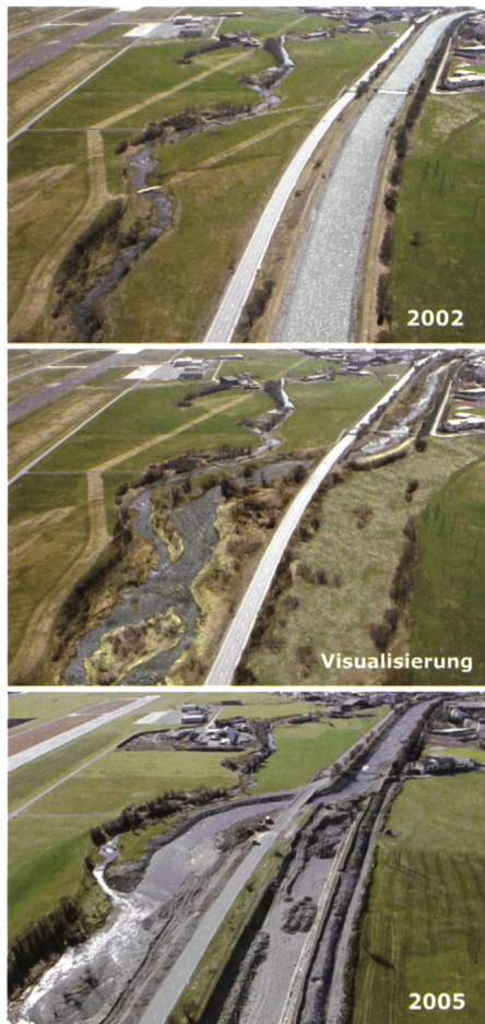
Bild 10. Rechte Bildleiste: Die En-Ausleitung (Blick En-aufwärts in südlicher Richtung): Die Ausleitung des En in das Gerinne des En-Altlaufs unterhalb Samedan war das Herzstück der gewässerökologischen Aufwertungen im System. Einige der in der Zwischenzeit durchgeführten Massnahmen sind auf dem Situationsbild von 2005 noch nicht sichtbar (z.B. Gestaltung des linken Ufers der Ausleitung; Auffüllung und Bepflanzung des alten Kanalgerinnes).
