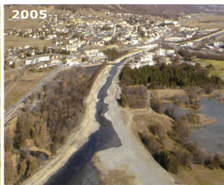
Bild 11. Zusammenfluss von Flaz vegl und En (Blick von Champagnatscha En-abwärts in nördlicher Richtung): Die auffälligste Veränderung im Bereich der alten Flazmündung ist die nun veränderte Wasserführung. Während 2003 En (von links) und der durch Gletschermilch getrübe Flaz (von rechts) noch weitgehend unvermischt durch Samedan flossen, enthält das nun restrukturierte En-Gerinne seit 2005 nur noch Wasser aus En und Flaz vegl.
