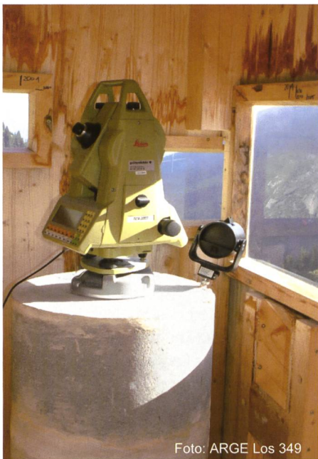
Bild 5. Tachymeter auf doppelwandigem Pfeiler in Schutzhaus.
