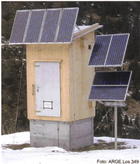
Bild 6. Solarstromversorgung für automatischen Tachymeter.
