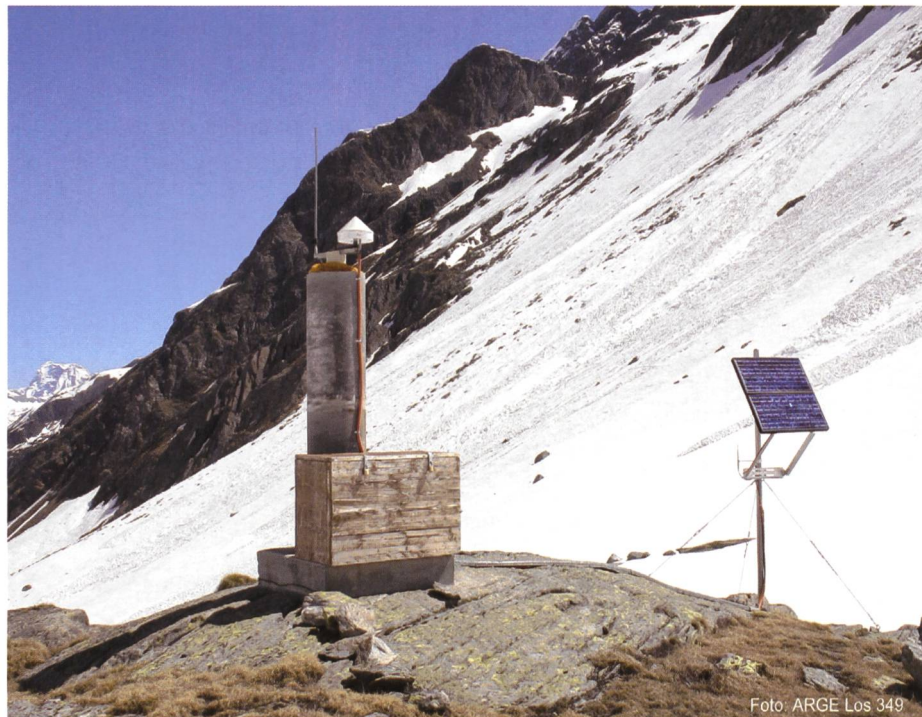
Bild 12. GPS-Messfeiler mit Antenne, Blitzfangstange, Elektronikbox und Solarpanel.
