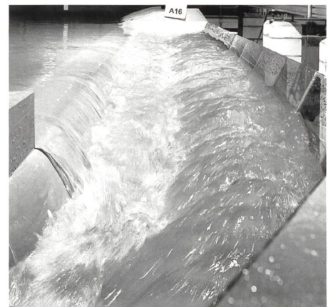
Bild 7. Ausgeschöpfte Abflusskapazität des Sammelkanals bei EHQ im Modell, gesehen entgegen der Fliessrichtung.
