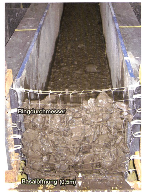
Bild 7. Labornetz an der WSL gefüllt mit Geschiebe; das verwendete Korngemisch hat einen mittleren Durchmesser, der etliches kleiner ist als die vorhandene Ringgrösse.
