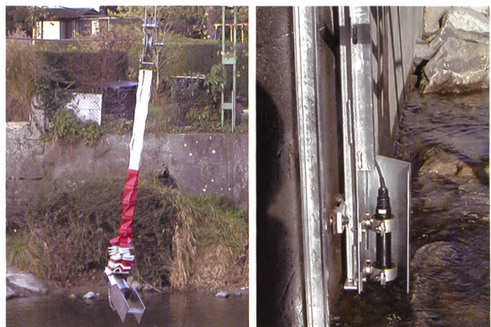
Bild 2. Schwebstoffbeobachtung, links: Beprobung mittels Seiflügelanlage; rechts: Trübungssonde.
