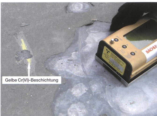
Bild 5. Voruntersuchung vor Ort mit mobilem Röntgenfluoreszenzspektrometer.
