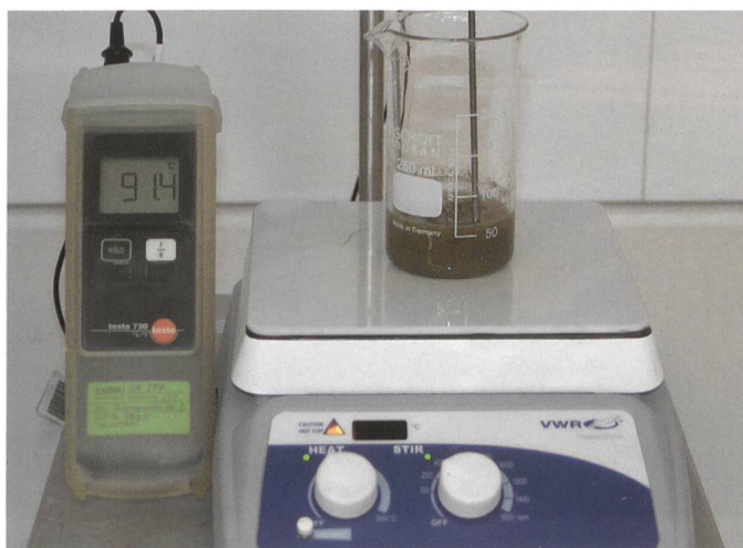
Bild 7. Selektives Lösen von Chrom(VI) in heisser alkalischer Lösung.
