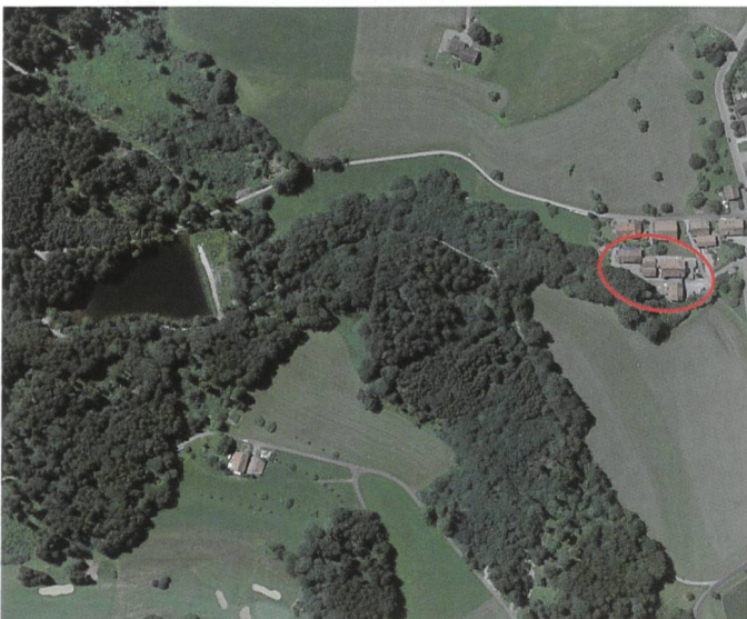
Bild 1. Luftbild des unteren Luppenweihers in Hittnau bei Pfärfikon ZH. Ehemalige Wasserkraftanlage von 1876, heute Naturschutzgebiet, Weiher mit 6 m Stauhöhe und 32000 m 3 Stauvolumen. Die ehemaligen Fabrikgebäude werden heute bewohnt und liegen im Flutwellenabflussgebiet bei einem allfälligen Dambruch. Diese Stauanlage ist aufgrund des Kriteriums der besonderen Gefahr der StAV zu unterstellen.
