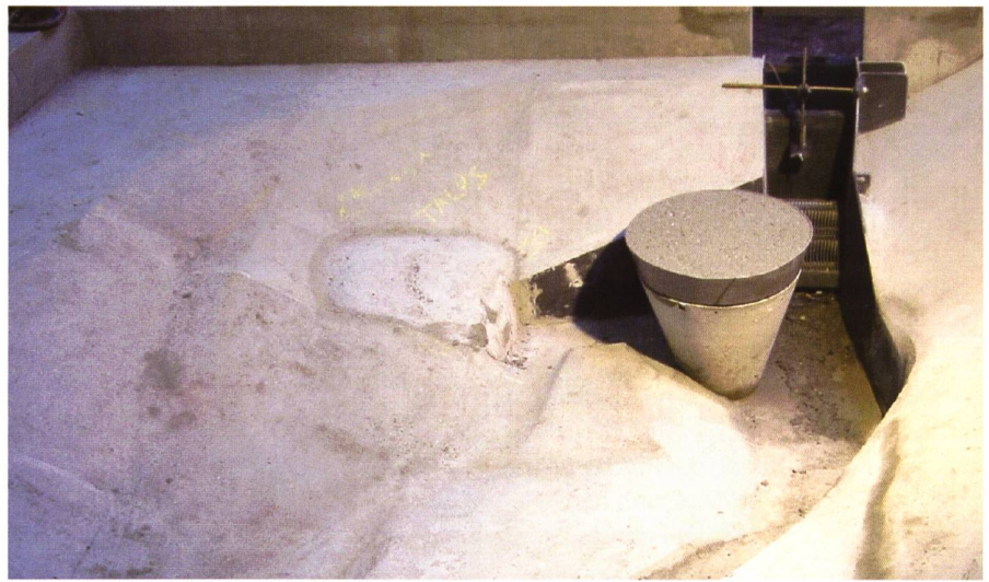
Bild 2. Sicht flussabwärts auf Geschiebesammler mit Einlaufbauwerk der Hochwasserentlastung und Auslaufbauwerk. Links: Das ausgeführte Bauwerk. Rechts: Das hydraulische Modell im Massstab 1:30.
