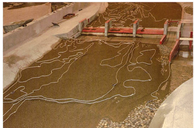
Bild 5. Geschiebeuntersuchung (Ansicht UW-seitig), Quelle: TU Graz.
