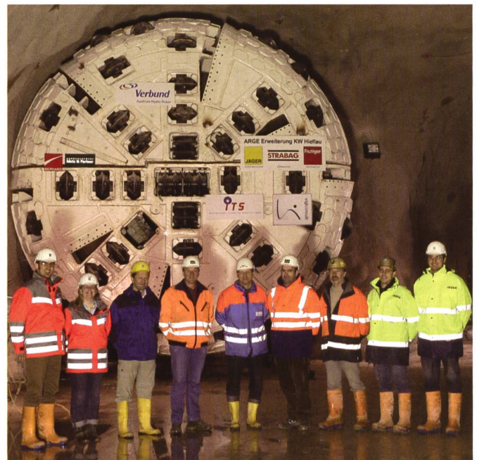
Bild 8. Fräskopf im Verzweigungsbereich des neuen Triebwasserweges.
