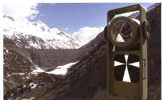
Bild 9. Präzisionsreflektoren für die Distanzmessung mit dem Mekometer ME5000.
