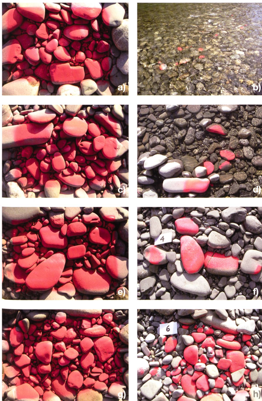
Bild 9. Geschiebetrieb bei Turbinierung bis zu 135 m 3 /s. Sohlenmarkierung bei US1. Markierung am 14.1.2007, Kontrolle am 21.1.2007. Entfernung vom rechten Ufer: 71 m (a, b), 52 m (c, d), 27 m (e, f), 16 m (g, h).
