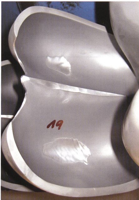
Bild 7. Laufrad 2 (mit Wolframkarbid-Beschichtung) nach 80 Volllasttagen während der Schwebstoffsaison.
