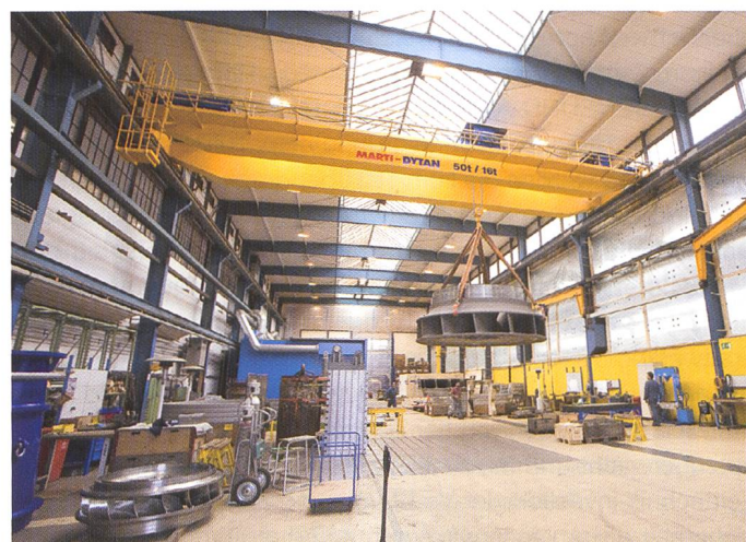
Bild 2. Die Turbinenlaufräder stellen einen hohen Wert dar. Deshalb müssen die Mitarbeitenden von Andritz Hydro mit höchster Konzentration die innerbetrieblichen Transportaufgaben erledigen.
