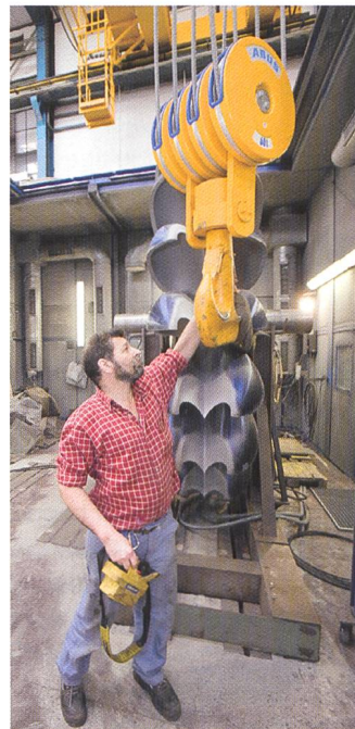
Bild 1. Vorbereitungen zum Abtransport eines Francis-Laufrades. (Bilder: P. Meier/Feurstein).
