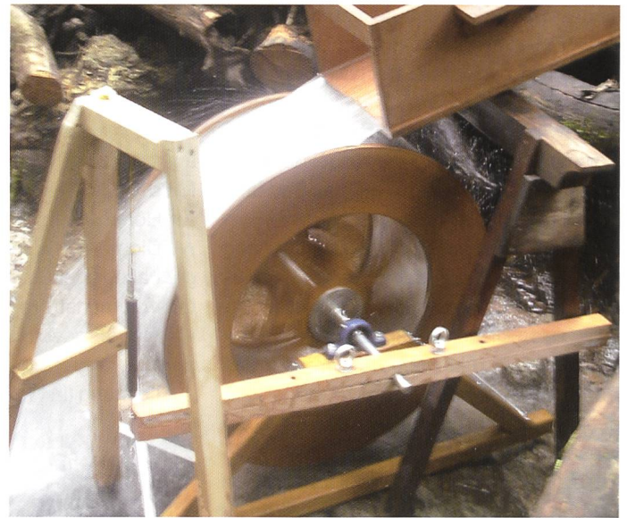
Bild 4.3. Die Prony-Bremse im Einsatz.
