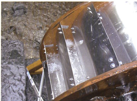
Bild 8.9. Sicht auf den Füllstand der Schaufeln.
