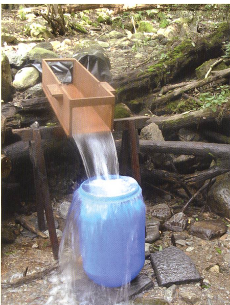
Bild 8.10. Messung der Wassermenge mithilfe eines 60 l-Fasses und einer Stoppuhr.
