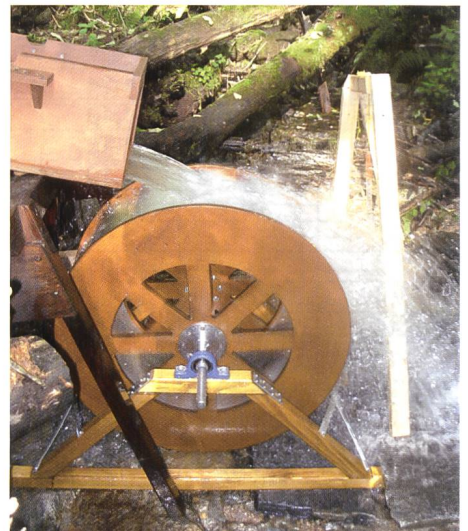
Bild 8.13. Grosses Gespritze bei geringer Belastung und viel Wasser.
