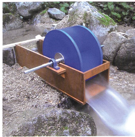
Bild 5.2. Unterläufiges Wasserrad in Betrieb.
