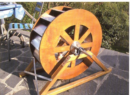
Bild 8.6. Oberläufiges Wasserrad vor dem Betrieb...
