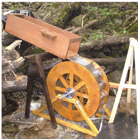
Bild 6.1. Das oberläufige Wasserrad fertig montiert im Bach.
