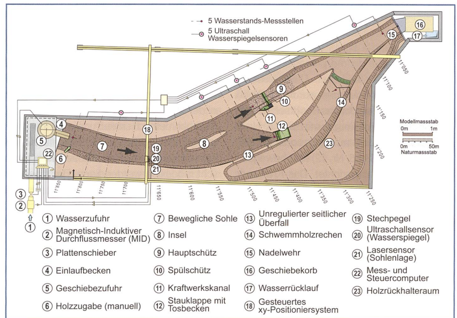
Bild 6. Übersicht des physikalischen Modells an der VAW auf Grundlage der vom Ingenieurbüro Maggia AG ausgearbeiteten Pläne, Modellmassstab 1:50.
