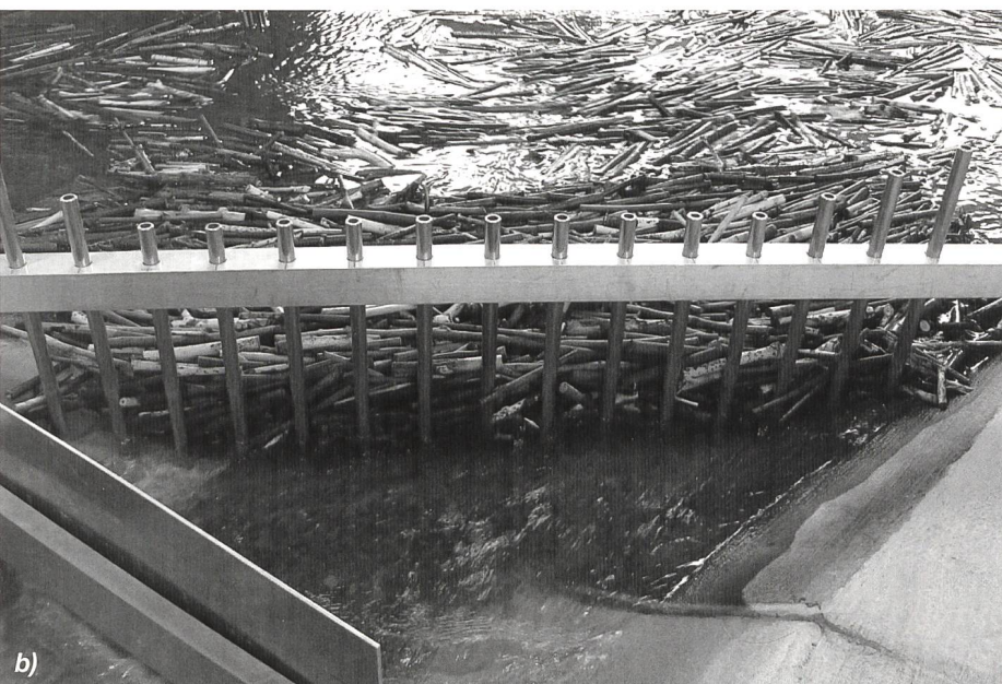
Bild 5. Nach Zugabe von 150 m 3 Festholz beim LF 8, (a) verklaustes Drosselwehr ohne und (b) freies Drosselwehr mit Drosselrechen.
