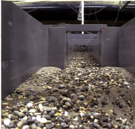
Bild 2. Modellversuch im hydraulischen Labor LCH an der ETH Lausanne ohne die Schwelle: Blick vom Hauptfluss in den aufgeweiteten Einmündungsbeereich des Seitenflusses. Durch die Aufweitung der Einmündung entsteht eine abwechslungsreiche Sohlenmorphologie. Diese ist Voraussetzung für neue Lebensräume und die Durchgängigkeit (Foto EPFL/LCH).
