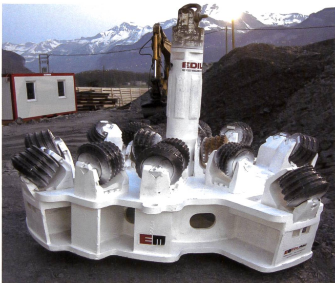
Bild 3. Der Bohrkopf verbreiterte die Pilotbohrung des Schachts auf drei Meter.
