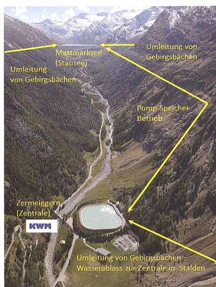
Bild 1. Übersicht des Vispertals (linkes Bild) und Luftbild der KWM-Werke im Saastal (rechtes Bild). Die Zahlen nummerieren die Wasserfassungen und die Zahlen in Klammern zeigen die Höhenlage an. Gelbe Pfeile illustrieren die Fliessrichtungen von unterirdischen Freiluft- und Druckstollen. Pfeile deuten die Fliess- und Pumprichtung in den Verbindungsstollen an. Alle Abbildungen modifiziert aus Finger et al. (2012) mit Erlaubnis der American Geophysical Union (AGU).
