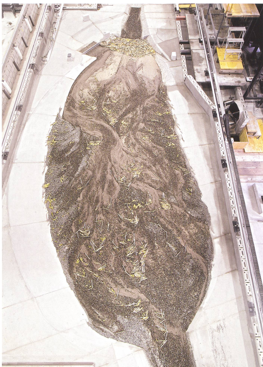
Bild 9. Schwemmholz- und Geschiebeablagerungen für optimierte Sammlerform nach HQ 300 .
