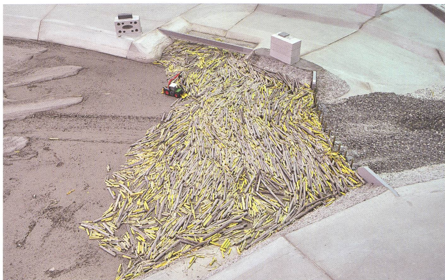
Bild 8. Schwemmholzteppich vor Rechen nach HQ 300 . Zur Verdeutlichung der Grössenverhältnisse ist ein massstäbliches Modell eines Greifbaggers abgebildet.
