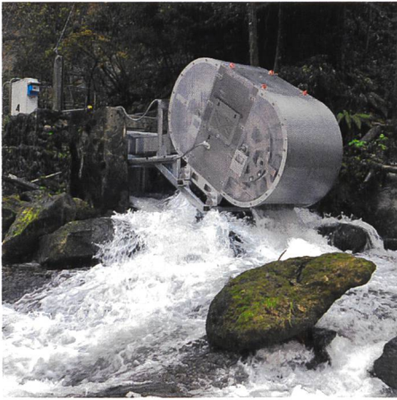
Bild. Die Steffturbine beruht auf dem fördertechnischen Prinzip und erreicht einen Wirkungsgrad von 92 Prozent.
