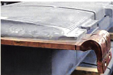
Bild 5. Erneuerung einer defekten Dämpferverbindung.
