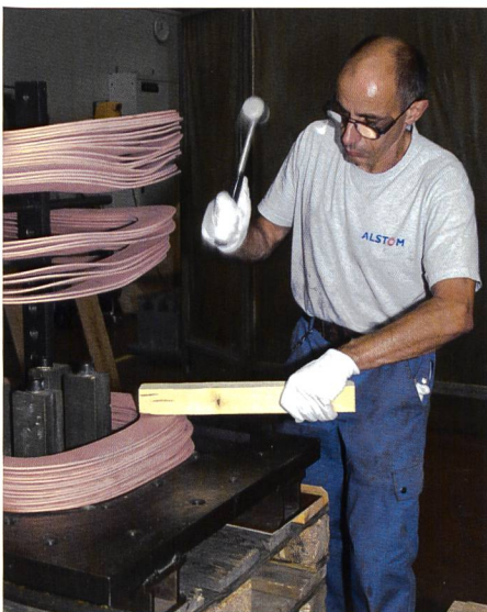
Bild 6. Neuinsolation einer Polwicklung.
